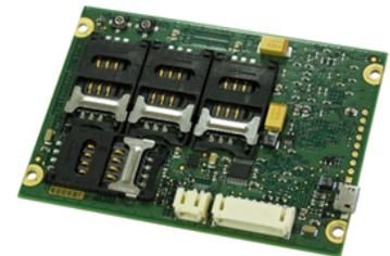
El nivel de seguridad del microcontrolador, está certificado por EAL4+. Este alto nivel de seguridad permite que el Lector gestione de forma segura todas las claves sin contacto necesarias para la comunicación con los diferentes medios inteligentes sin contacto. Estas claves se almacenan y protegen en el microcontrolador seguro.
